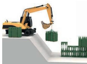
Exemple de cagettes-réservoir enterrées (RigofilST)
